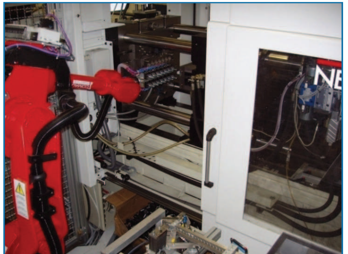
Mise en place des vis dans le moule
