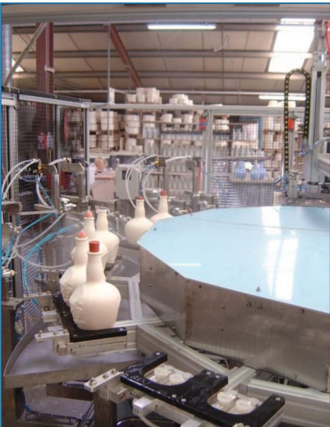
Poste de pulvérisation d'eau
