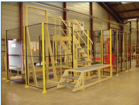
Estrade pour mise en place d'une housse
